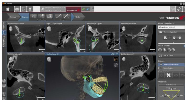
L'integrazione digitale e senza soluzione di continuità di tre tipi di dati in Function, rende visibile la complessa interrelazione: i dati della CBCT, del Jaw Motion Tracker (SICAT JMT+) e della scansione ottica di superficie sono combinati in SICAT Function. L'integrazione dei dati sul movimento della mandibola consente di progettare restauri che tengono conto della dinamica effettiva della stessa. Questo processo è compatibile con tutti gli scanner e tutti i CBCT.
